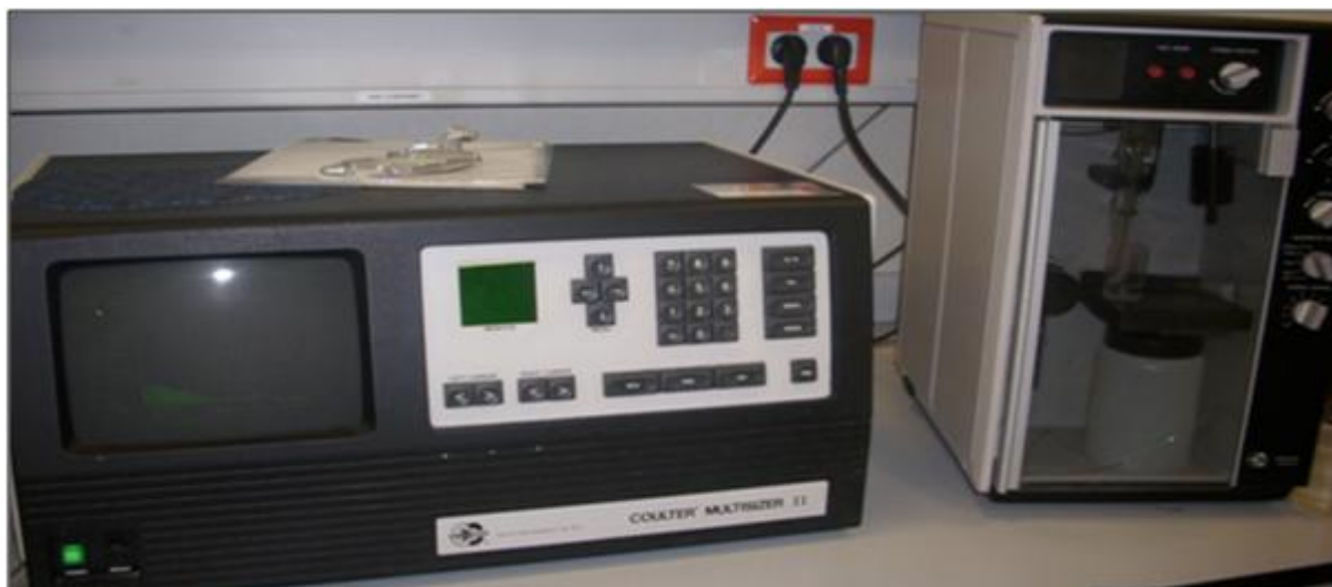
Figure 18 : Appareillage Coulter Multisizer II utilisé (Photographie de O. EL HACHEMI).
