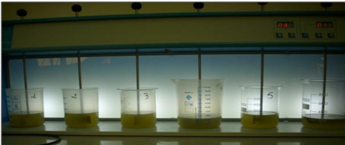
Figure 21: Photographie des essais de jar-test réalisés sur l'effluent final de la station Hammam-Foukani (Photographie de O. EL HACHEMI).
