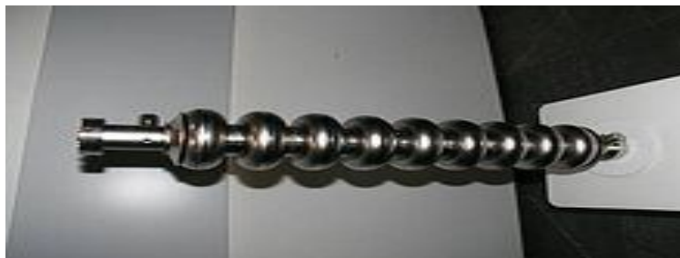
Figure 8: Accélérateur linéique pluricellulaire [22]
