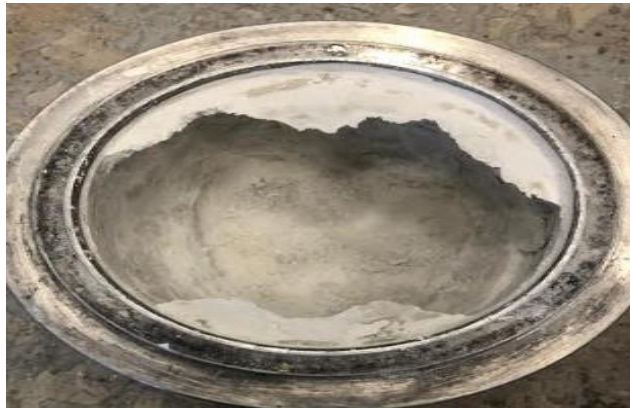
Figure A3 : Photo des PGP collées sur les jarres en dépassant 5 min avec une vitesse de 400 tr/min.
