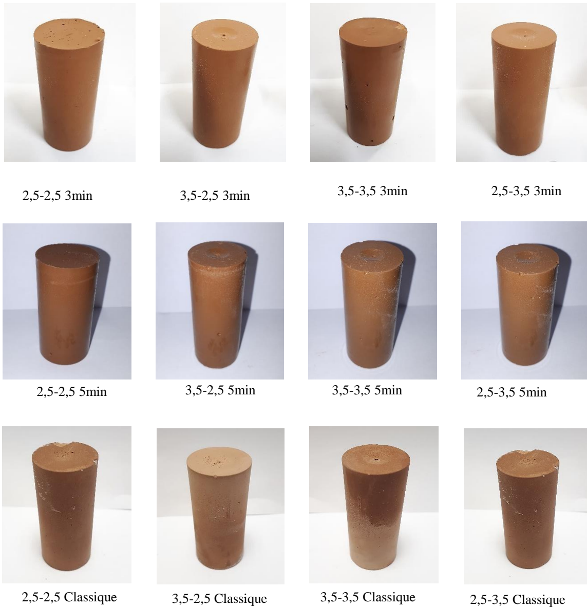
Figure A8 : Photos des différents géopolymères produits à base d'AFG.
