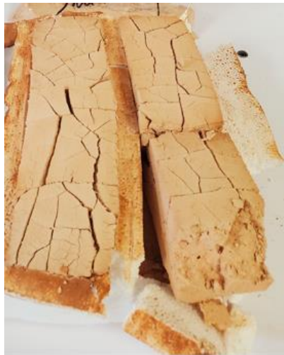
Figure A5 : Pâtes géopolymères à base de MK et CaO par méthode classique.
