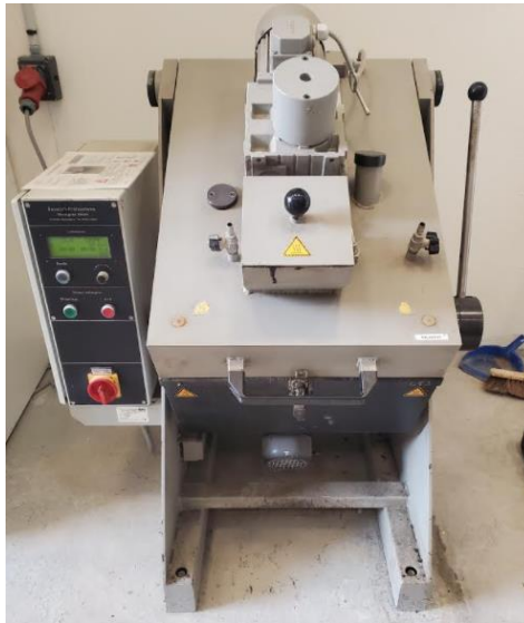
Figure II-21 : Malaxeur pour enrobés bitumineux.
