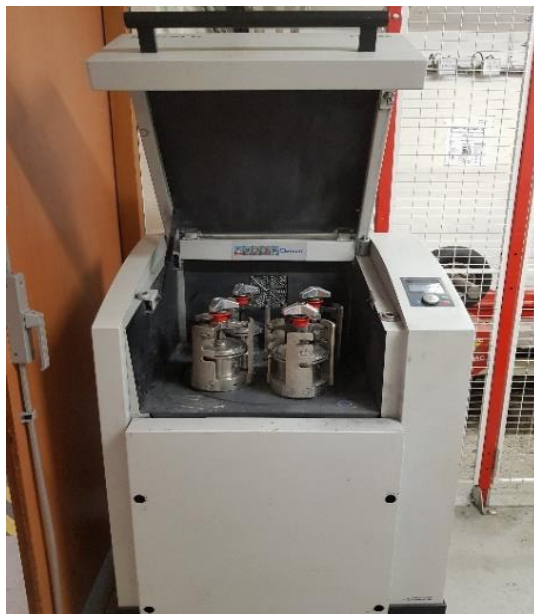
Figure II-5 : Broyeur planétaire (Retsch PM 400).
