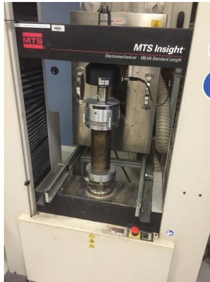
Figure II-24 : Presse électromécanique employée pour l'essai de tenue à l'eau (MTS).
