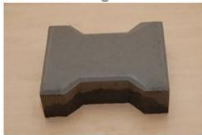
Figure I-23 : Section de bloc de pavé à base de ciment géopolymère [115].
