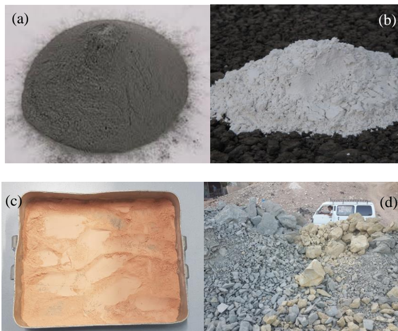
Figure II-2 : Photos des précurseurs aluminosilicates utilisés (a) CV, (b) LHF, (c) MK et (d) AFG.
