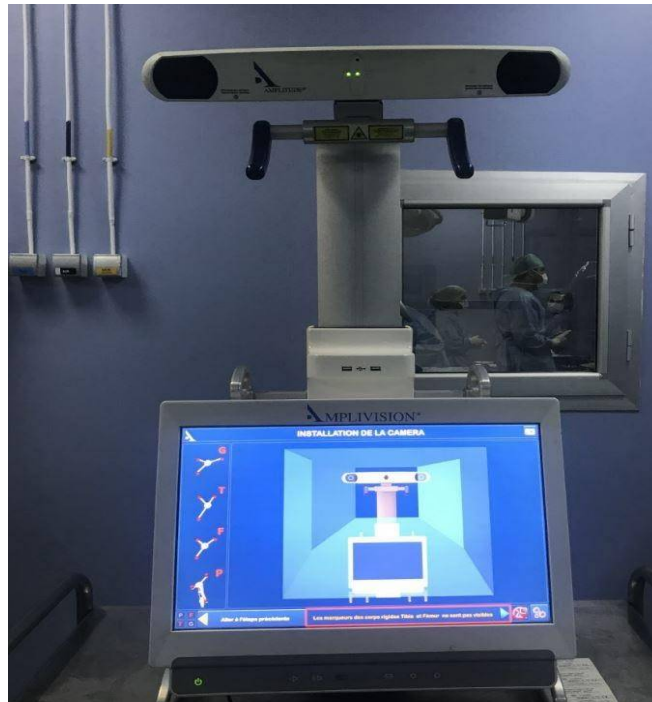
Figure 4 : La colonne de navigation du système Amplivision™.
