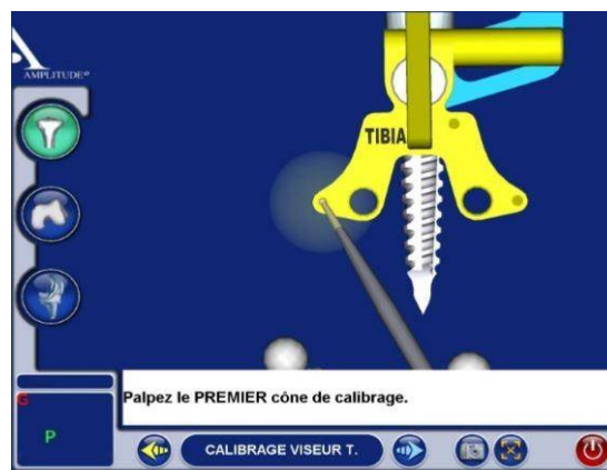
Figure 15 : La numérisation de la position du taraud.
