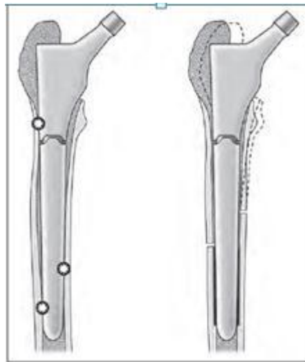
Figure 64: le choix d'une tige droite impose une ostéotomie quand le fémur est courbe.
