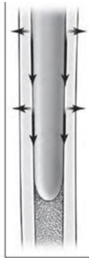
Figure 65 : une forme conique crée une force horizontale stabilisante et diminue la force verticale de cisaillement.
