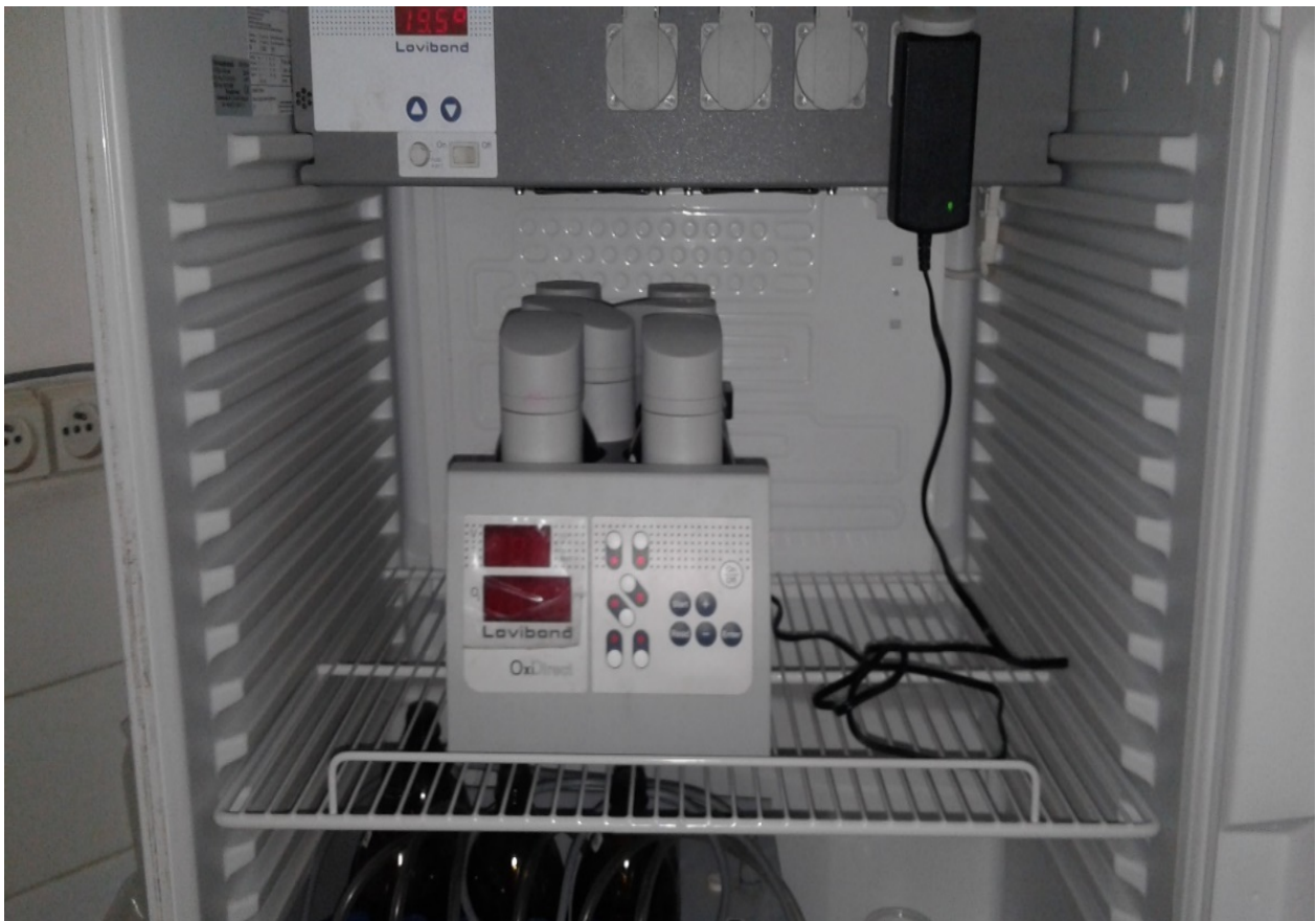
Figure II.3 L'appareil OxiDirect permettant de mesurer les valeurs de la DBO
