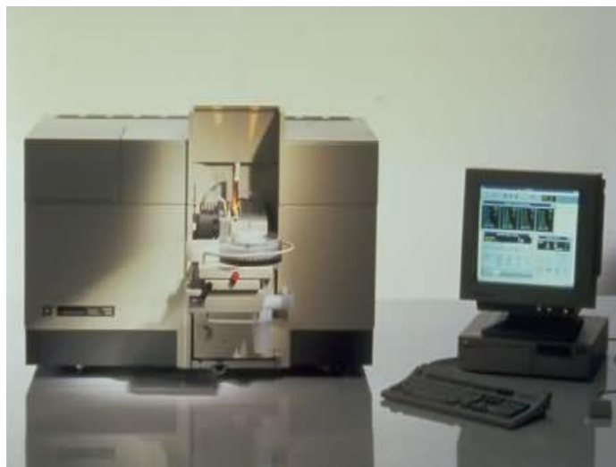
Figure 7 : Spectromètre d'absorption atomique Perkin Elmer GFAAS SIMAA de l'Institut National d'Hygiène de Rabat.
