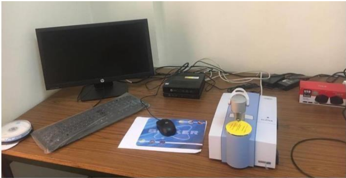
Figure 2-10. Spectromètre infrarouge à transformée de Fourier type Bruker Alpha Platinum-ATR.
