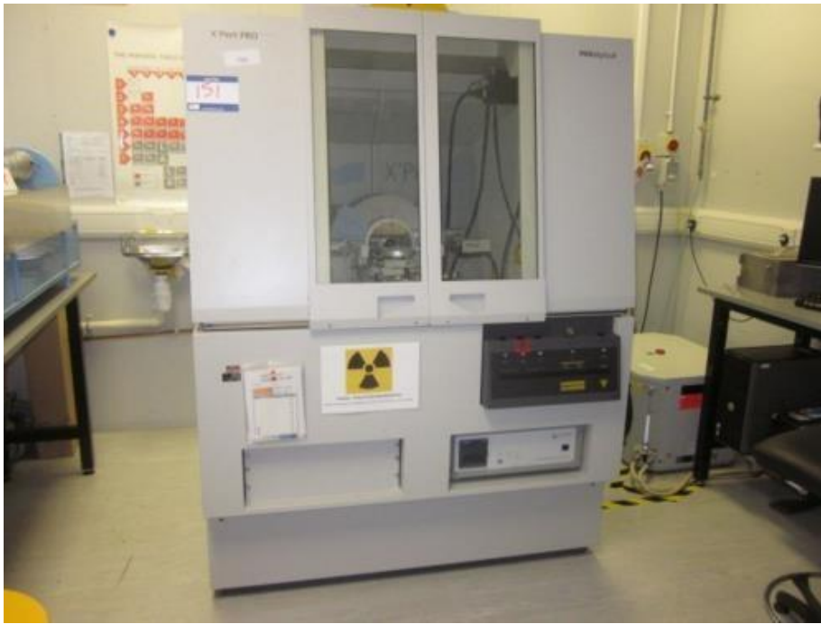
Figure 2-6. Diffractomètre Philips X'Pert Pro MPD.
