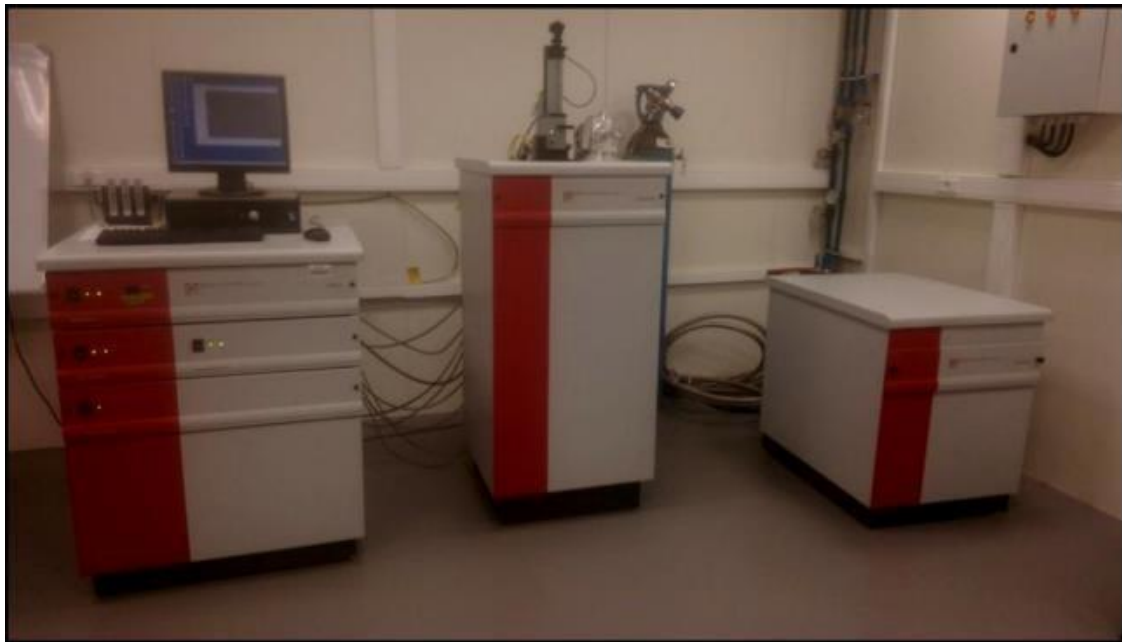
Figure 2-15. Photo de SQUID Quantum Design utilisé pour les mesures magnétiques.
