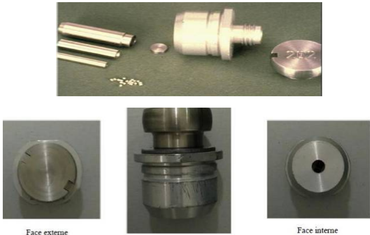
Figure 9: Montrant des sources de cobalt et des capsules les contenant.
