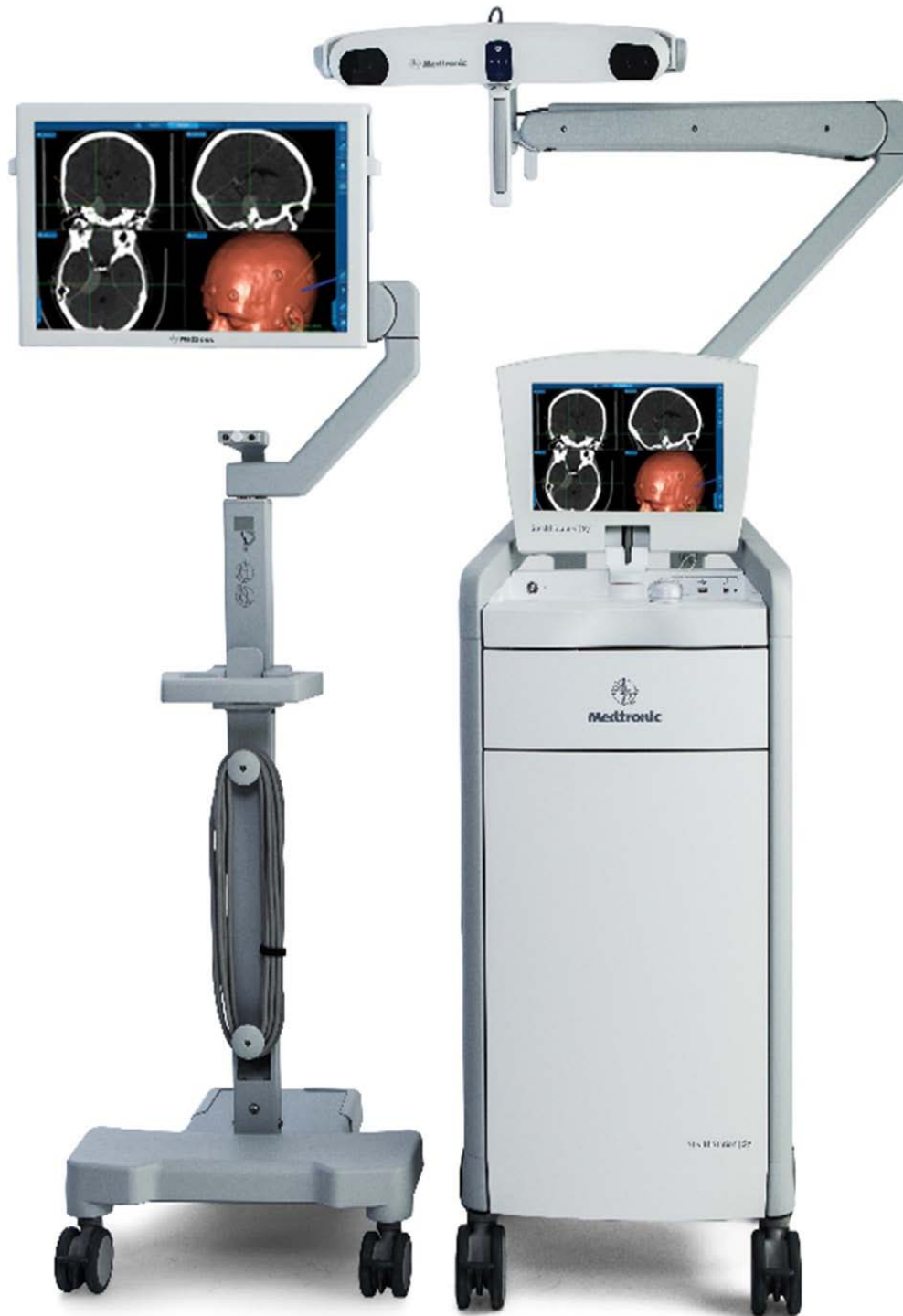
figure 10 : S7 StealthStation de Medtronic. Le S7 est un modèle récent de la plateforme de chirurgie guidée par l'image de Medtronic. Sur la gauche se trouve un grand écran tactile haute définition. À droite se trouve l'ordinateur de navigation et le poste de travail de planification. Notez que la caméra infrarouge utilisée pour le suivi optique est attachée au poste de travail et positionnée au-dessus du champ opératoire
