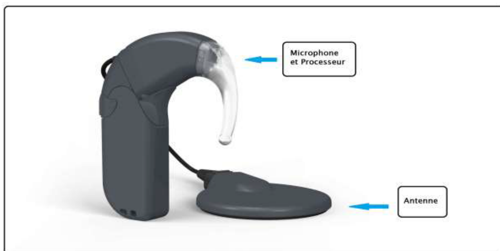
Figure 53 : Partie externe d'un implant cochléaire [40]
