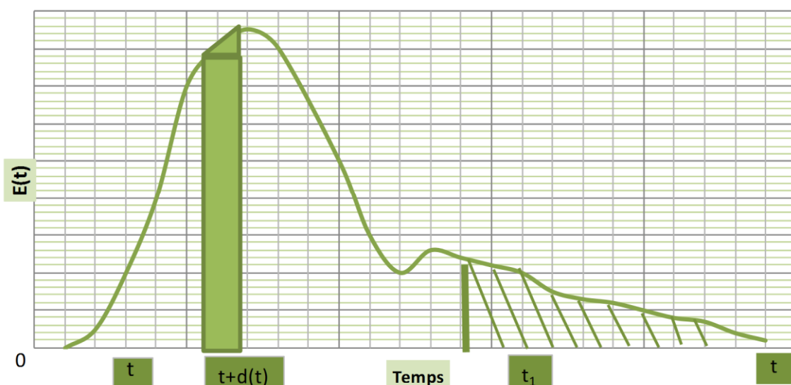
Figure (2). La distribution des temps de séjour ( E(t)dt est la fraction du débit de sortie).
