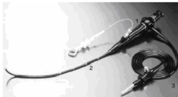
Figure1: Anatomie d'un fibroscope. Trois parties principales: 1.poignée de commande; 2. gaine principale; 3.cordon de liaison au générateur.
