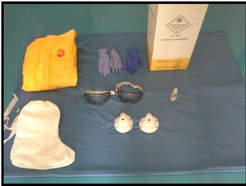
Figure 14: Equipement de protection individuelle : combinaison, gants, masque, lunettes, surchaussures (photo du LRB-P3. HMIMV)
