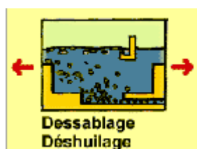
Figure A.II.2 : Processus de Dessablage/Déshuilage
