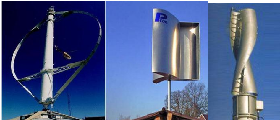
Figure 1.6: Éoliennes à axe vertical
