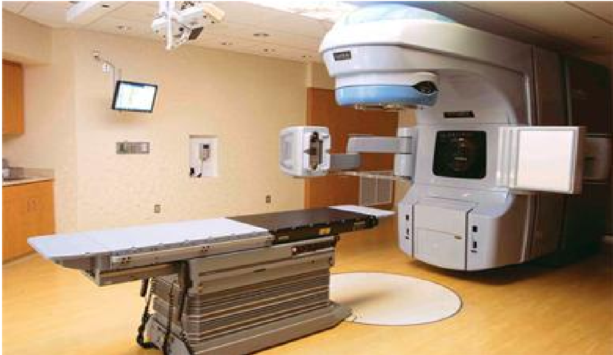
Figure 10 : accélérateur linéaire ou LINAC (site internet de Brainlab ® )
