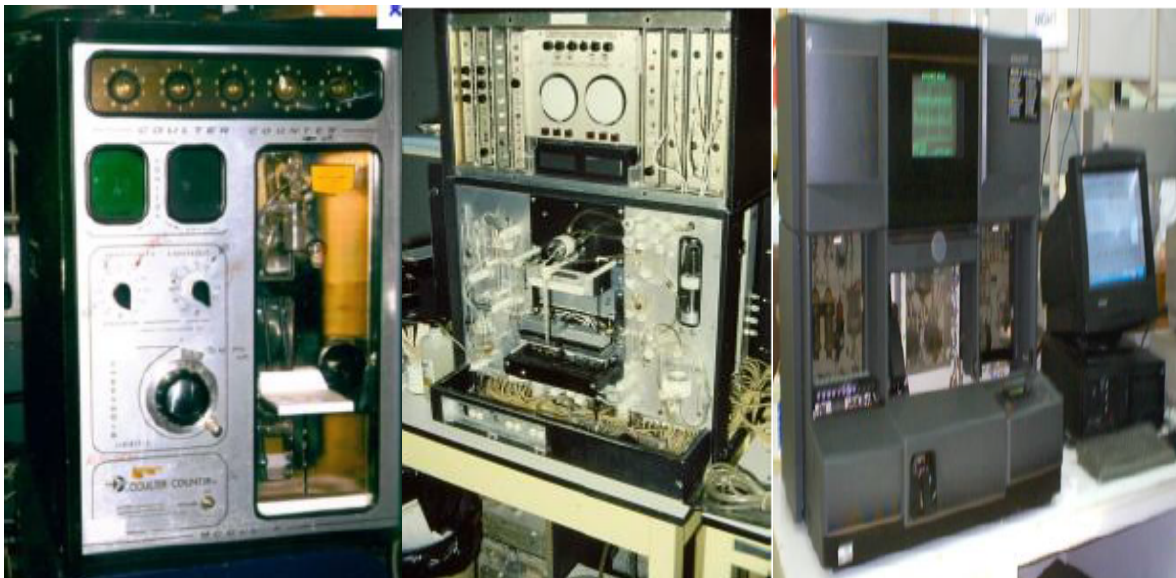
Figure 2: A gauche Coulter modèle F (années 70) ; au centre Coulter modèle S (années 80) ; à droite Coulter modèle STKS (années 90) (Impédance, radiofréquence et diffraction laser) [7]
