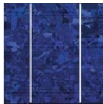
(B) cellule poly-cristalline
