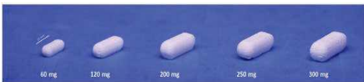
Figure 7 : Imprimés de théophylline à dosages croissants fabriqués par FDM [20]
