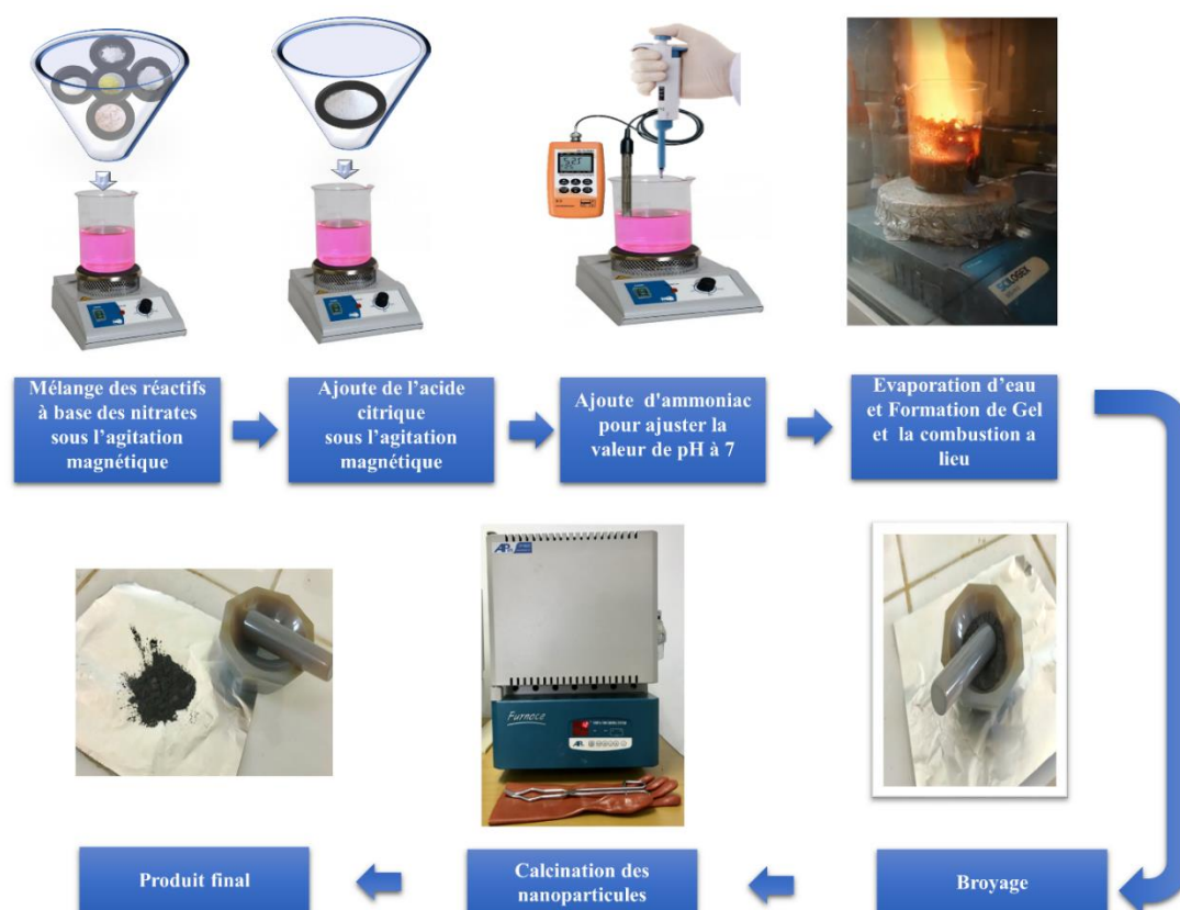
Figure 5. 1 Processus de préparation d'hexaferrite par la voie sol-gel auto combustion
