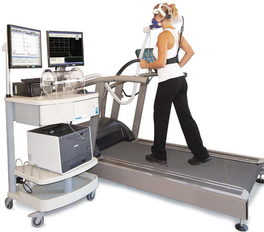
Figure 6 : Mesure de la VO 2 max sur un dispositif moderne de la mesure des échanges gazeux durant un exercice incrémental sur tapis roulant (97)
