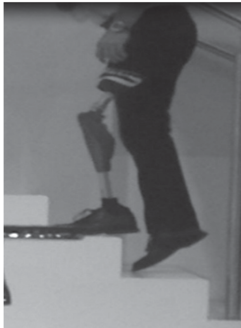
Figure 53 : Genou Genium permettant la montée des escaliers grâce à l'association de gyroscope et de microprocesseurs[106]
