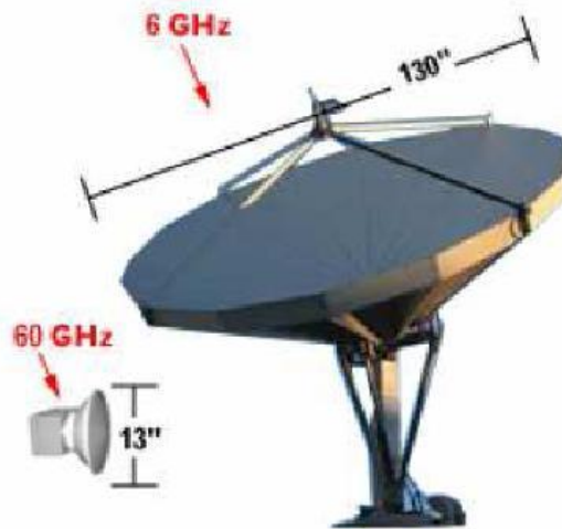
Figure 1.5. Comparaison entre une antenne à 6 GHz et une antenne à 60 GHz
