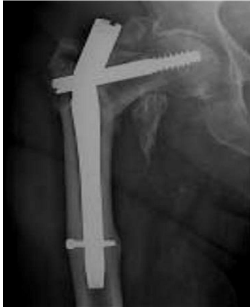
Figure 84 : fracture du clou sur l'orifice dynamique (après 6 mois) (56***).
