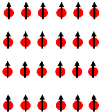
FIGURE 1.1 – Un matériau ferromagnétique.
