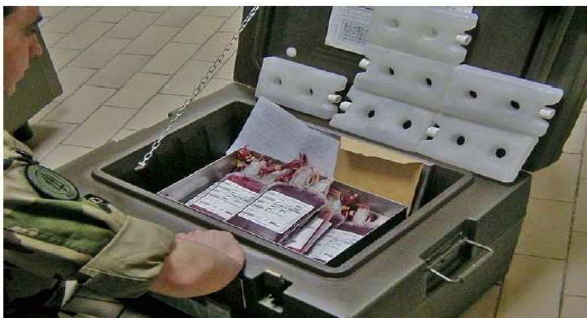
Fig.21 : Dotation de 30 CGRD conditionnés pour un transport entre +2 °C et +10 °C.
