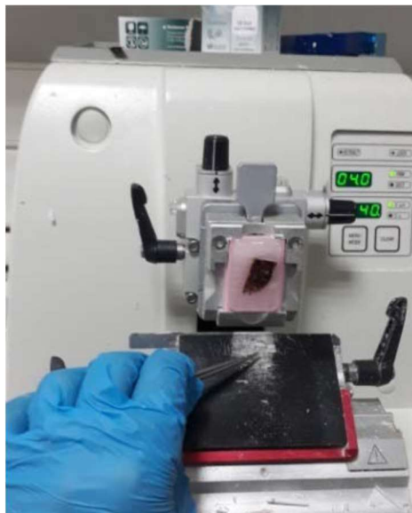
Figure 7: Après enrobage en paraffine, une coupe des prélèvements étudiés au microtome automatique, Service d'Anatomie Pathologique CHU, Mohammed VI Marrakech
