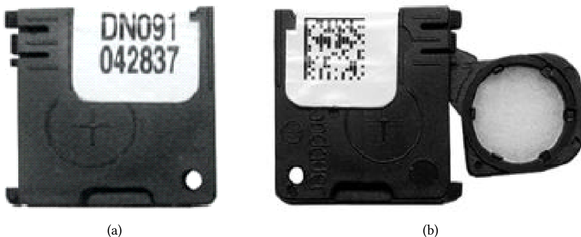
FIGURE 38 – Dosimètre InLight nanoDot de Landauer Inc montrant (a) l'élément sensible fermé et (b) l'élément sensible exposé.
