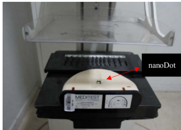
FIGURE 49 – Représentation du dispositif expérimental en utilisant OSL nanodots.
