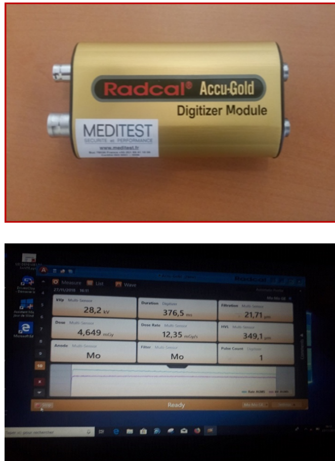
FIGURE 33 – Système de digitalisation Accu-Gold et son logiciel.
