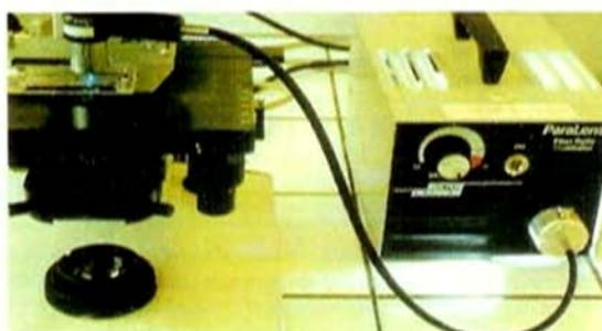
Photo 5. Microscope optique standard équipé du système de lecture du QBC Malaria Test.
