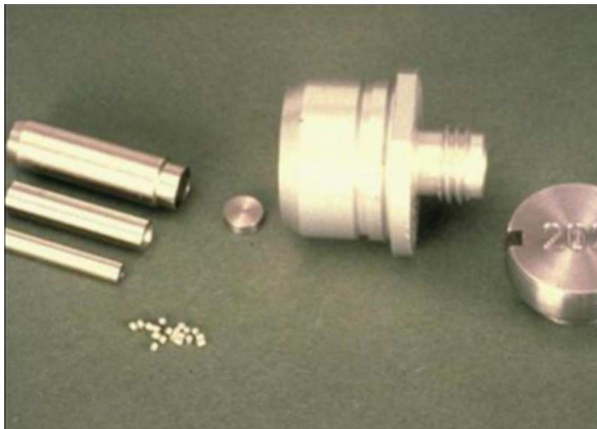
Figure 5: Les sources du cobalt 60 utilisées en radiochirurgie(8).
