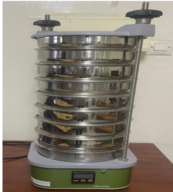
Figure 27 : Un tamiseur à vibration
