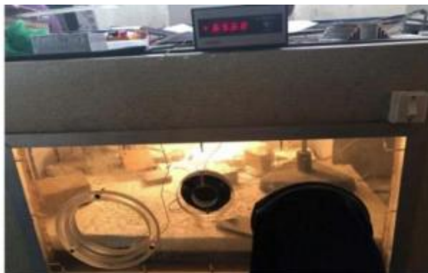
Figure 33 : Boîte à gant thermo régulée en fonction de la température
