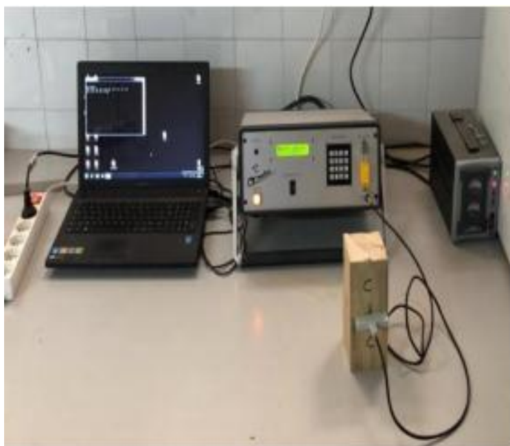
Figure 35 : Lancement d'échantillons d'Araucaria dans l'appareil CT-Mètre
