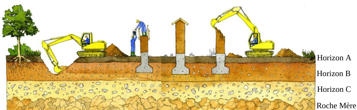
Figure 2 : Cycle de vie de la terre crue : extraction, construction, utilisation, démolition et recyclage. Source : Arnaud Misse.
