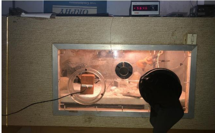
Figure 26 : Boîte à gants hermétique régulée en température de 15°C à 80°C
