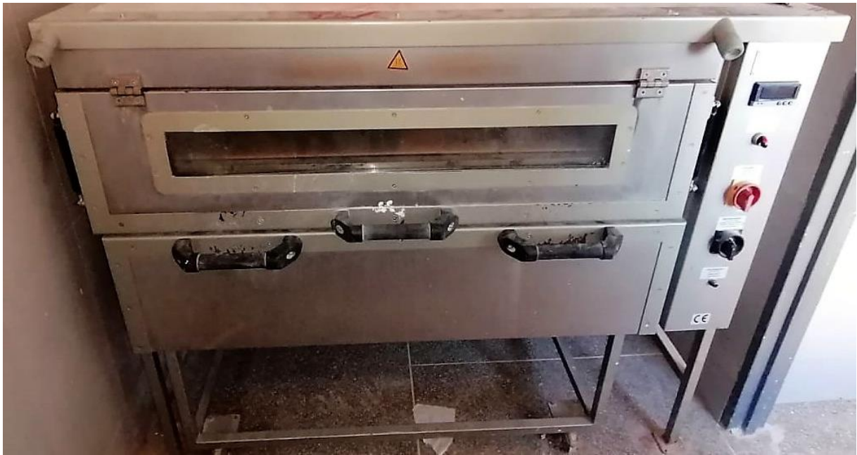
Figure 23: Four électrique avec plaque chauffante
