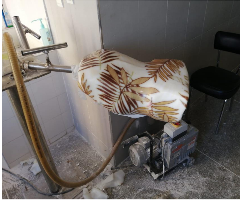
Figure 29: Aspect de corset après thermoformage et avant finition
