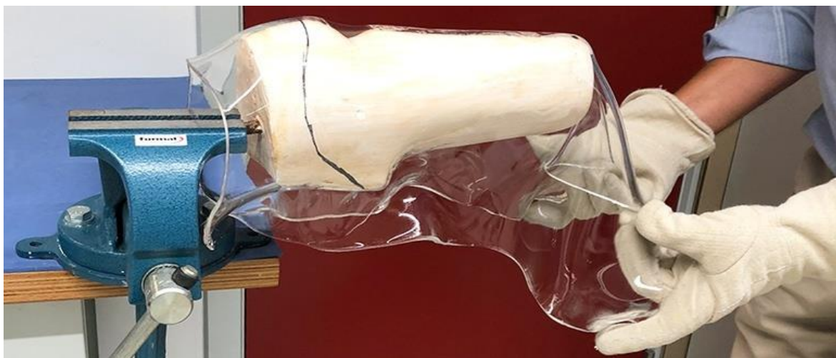
Figure 62: Thermoformage par matériel thermoplastique chauffé [4]
