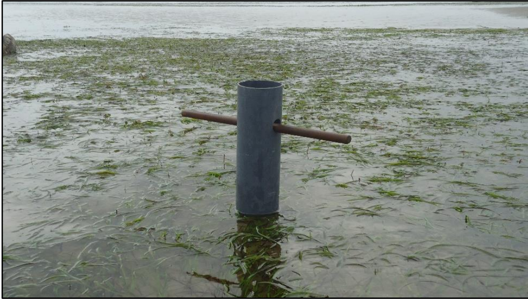
Figure 12 : Photo illustrant le carottier manuel utilisé pour l'échantillonnage des herbiers de Zostera notlei .
