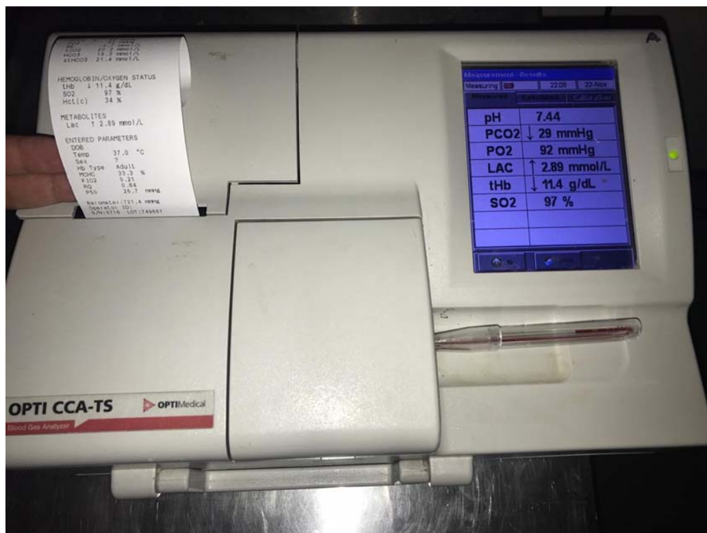
Figure 4 : Analyseur OPTI ® CCA-TS utilisé pour la détermination des lactates artériels et les gaz du sang lors de l'étude
