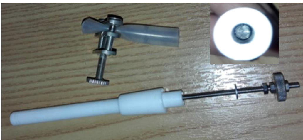
Figure III-1 : Electrode à pâte de carbone de surface renouvelable
