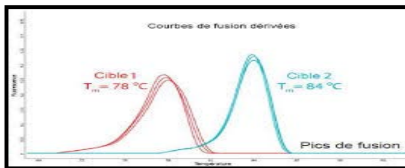
Figure 8 : Représentation des dérivées des 3 courbes de fusion pour 2 cibles différentes
