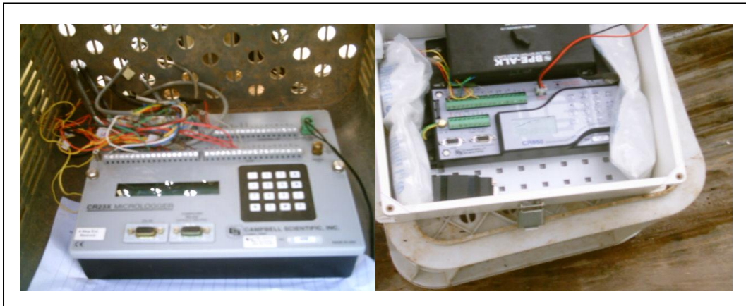
Figure 2. 3 : Data logger type Campbell scientifique CR23 et CR850
