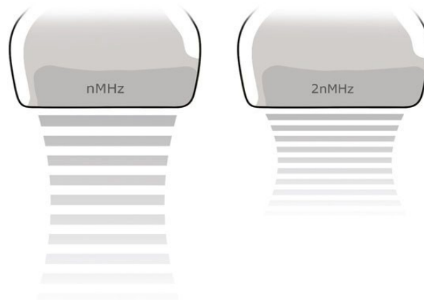
Figure 28 : Représentation schématique de l'atténuation en fonction de la fréquence (élevée ou basse) pour une même sonde
