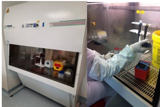
Figure 6: Poste de sécurité microbiologique(PSM) (laboratoire de virologie HMIMV)
