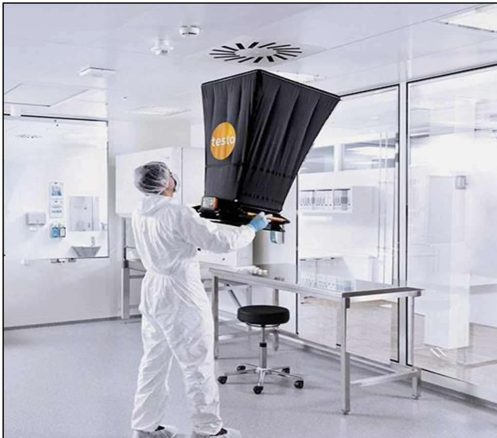
Figure 39 : Balomètre de mesure des débits volumétriques. [295]
