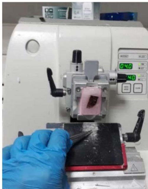
Figure 13: Après enrobage en paraffine, une coupe des prélèvements étudiés au microtome automatique, Service d'Anatomie Pathologique CHU, Mohammed VI Marrakech
