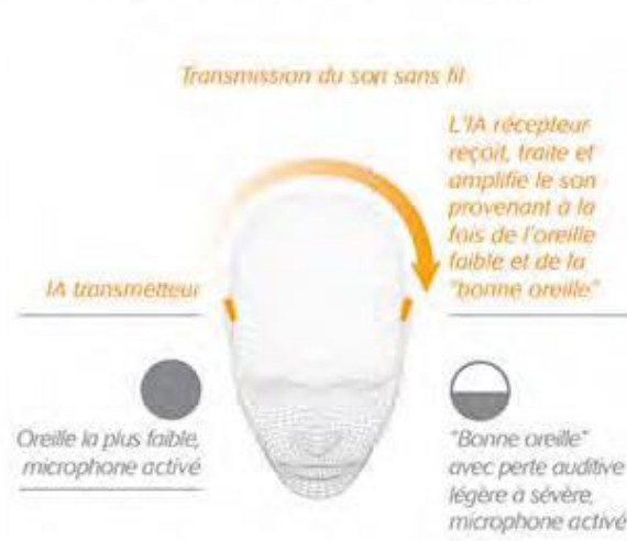
Figure 52: Schématisation des systèmes CROS et Bi-CROS(55)
