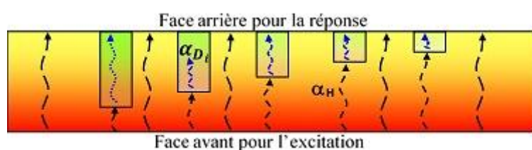
Figure V.15 : Illustration typique de transmission de la température à différentes profondeurs dans l'échantillon
