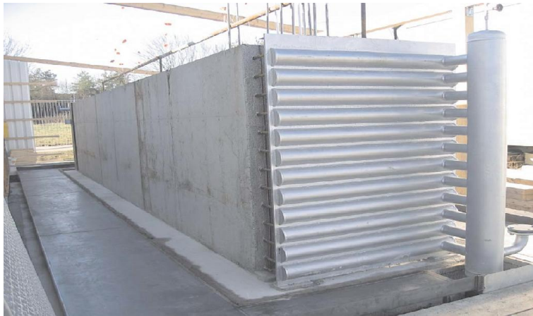
Figure II-21 Module final de test (sans isolation thermique) (Laing, D 2009)
