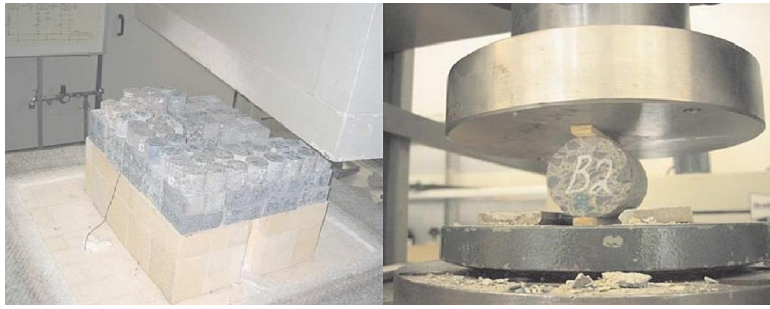
Figure II-20 Essais de béton : sondes de cycle thermique "à gauche" et test de résistance à la traction "droite" (Laing, D 2009)
