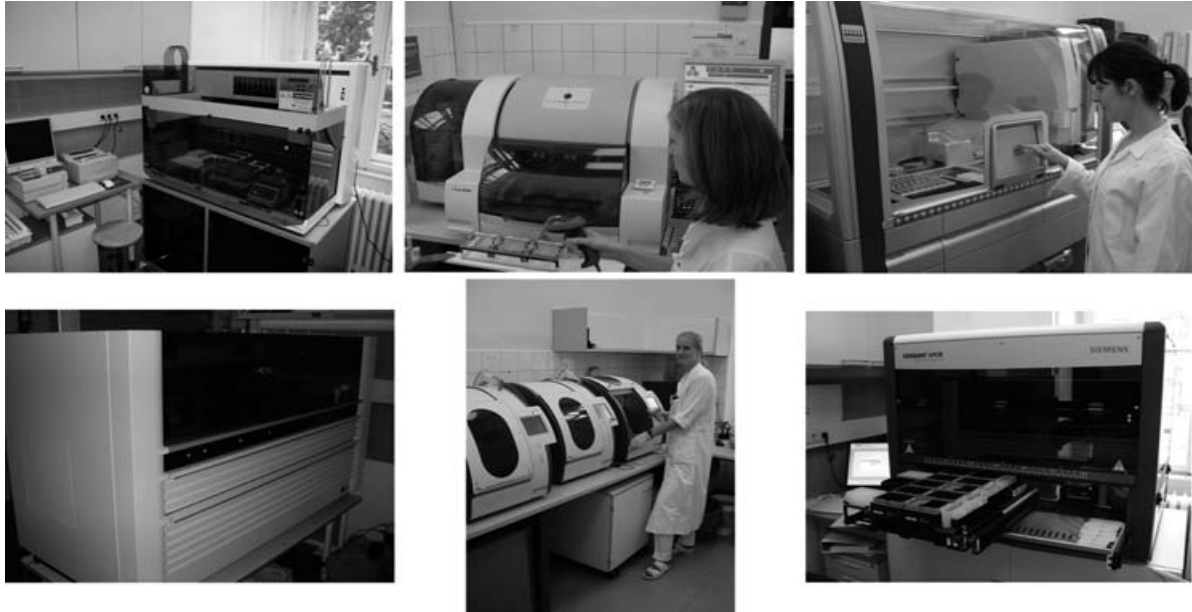
Figure 9 : Plateformes disponibles sur le marché les plus utilisées actuellement pour l'extraction des AN en routine diagnostique. Rangée supérieure (de gauche à droite) : m2000sp (Abbott), NucliSens easyMAG (bioMerieux), et QIAAsymphony (Qiagen). Rangée du bas (de gauche à droite): COBAS AmpliPrep (Roche), MagNA PureCompact (Roche), et kPCR SP (Siemens) [7].
