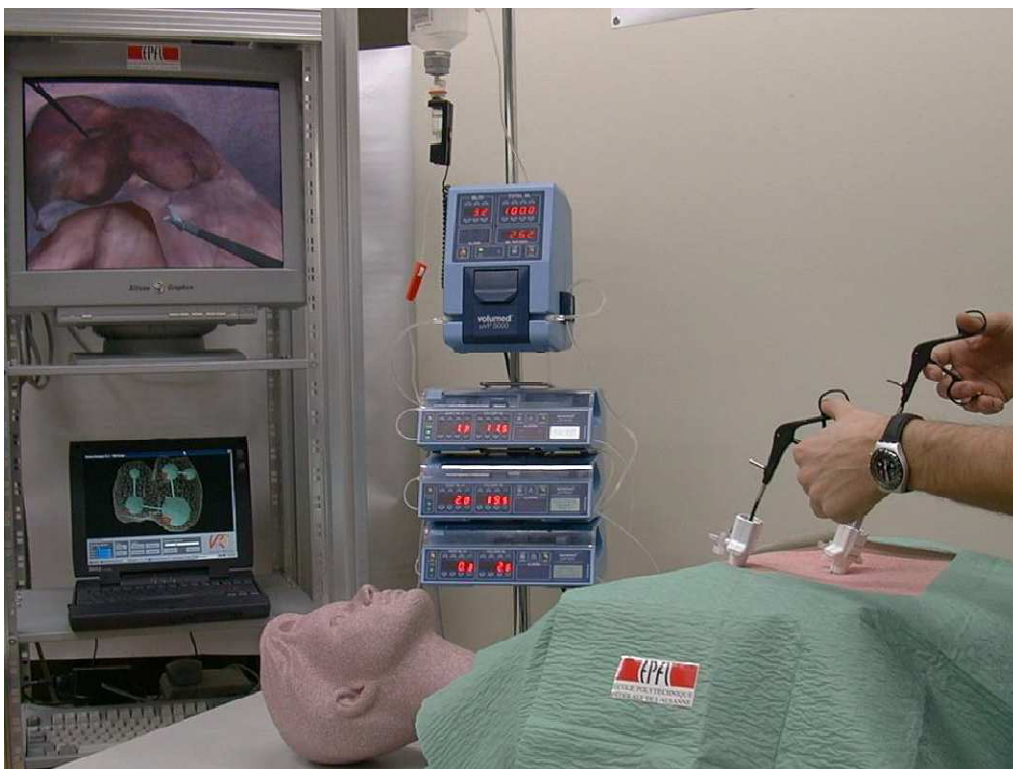
Figure 50: simulateur pour la cœliochirurgie - (EPFL)[4].
