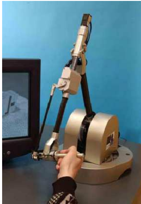
Figure 43: exemple d'un outil à retour d'effort (Haption) utilisé dans un simulateur d'enseignement assisté par ordinateur[4].
