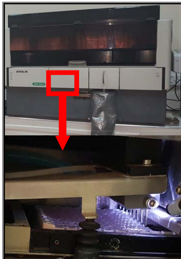
Figure 7 : EVOLIS™ processeur de micro-cartes autonome destiné aux tests ELISA automatisés.
