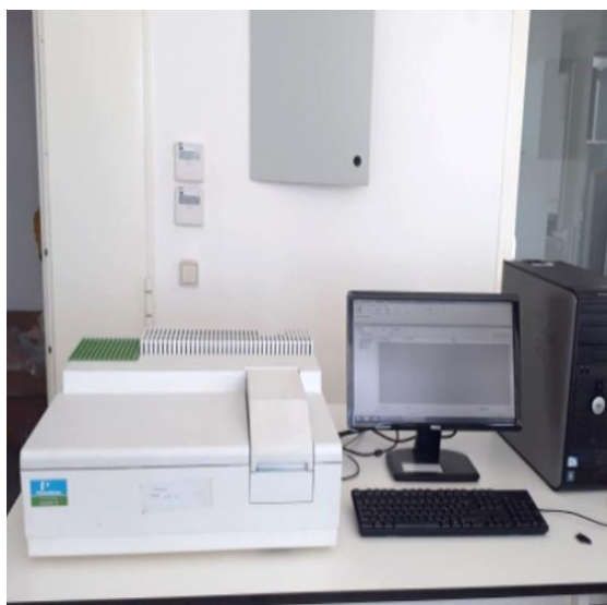
Figure 17. UV-Vis LAMBDA 52 Perkin Elmer (UATRS-CNRST)
