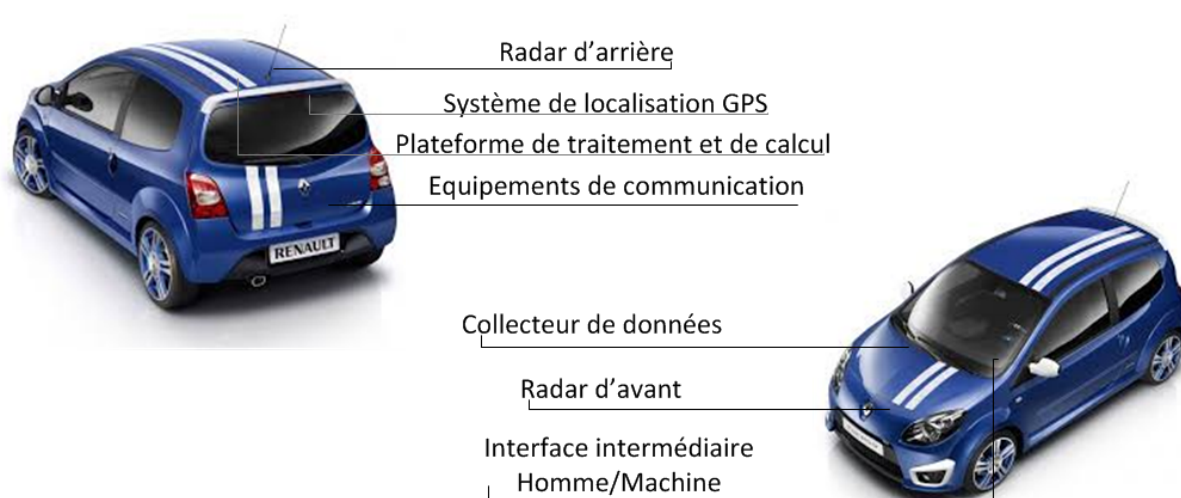
FIGURE 1.3 – Composants physiques d'un véhicule intelligent
